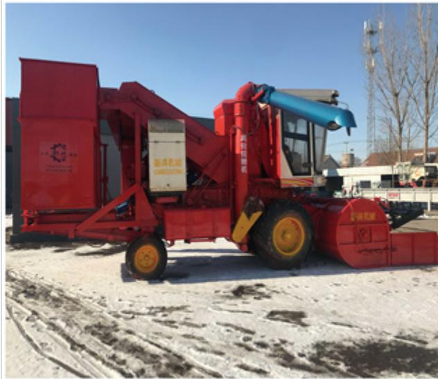
玉米脱粒机安全防护设备有必要完竣且平稳可靠，脱粒机的全部高速改变件都理应有平稳可靠的防护罩或防护板，通常以事变状况下人的四肢不易干戈到高速改变件为底子绳尺。安全警示标识表记标帜有必要完好且典范，通常在脱粒机的喂进口、出料口、风机口、输送带和夹持链等危险部位都理应有长久性的安全警示标识表记标帜，提示把持者过细安全。在选购时，要仔细打量脱粒机的三包规矩，尽可能选购三包期长、处事搜集健全、易损件供应有确保的脱粒机。在选购时，要仔细阅读脱粒机垂危技能参数和作业功能数据表，归纳思考脱粒机的适用范围、配套动力、作业从命、能耗、脱净率、损失率、含杂率等技能政策，经过进程比较后选购经济适用的机型，且不可片面追求机型较大的大体标称从命较高的机型。
